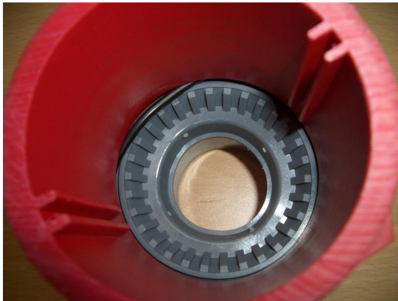
Junta pellizcada sin rotura
