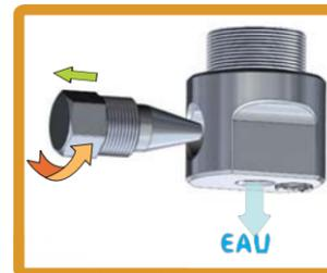
Pour enlever le condensat, dévissez la vis de fermeture à la main ou à l'aide d'une clé fixe n°13. Il n'est pas nécessaire de retirer la vis, il suffit de la desserrer jusqu'à ce que l'eau commence à couler.
