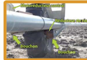
Remplacez le bouchon standard du réducteur de la roue ou du motoréducteur central par la Purga-PIVOT
